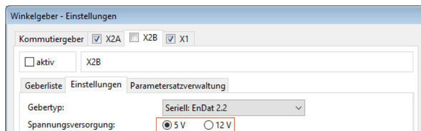
Abbildung 25: Winkelgeber-Einstellungen: Parametrierung der Versorgungsspannung
